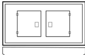
Шумозащитный кожух является одним из вариантов исполнения электростанции и предназначен для снижения уровня шума работающего оборудования до нормируемых пределов. Данное решение позволяет устанавливать и эксплуатировать дизель-генераторное оборудование в местах постоянного нахождения людей, т.е. имеющих ограничения по уровню шума, а также защищает оборудование от неблагоприятных внешних воздействий, что делает возможным установку ДГУ даже на открытом воздухе.
