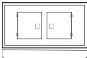
Шумозащитный кожух является одним из вариантов исполнения электростанции и предназначен для снижения уровня шума работающего оборудования до нормируемых пределов. Данное решение позволяет устанавливать и эксплуатировать дизель-генераторное оборудование в местах постоянного нахождения людей, т.е. имеющих ограничения по уровню шума, а также защищает оборудование от неблагоприятных внешних воздействий, что делает возможным установку ДГУ даже на открытом воздухе.
